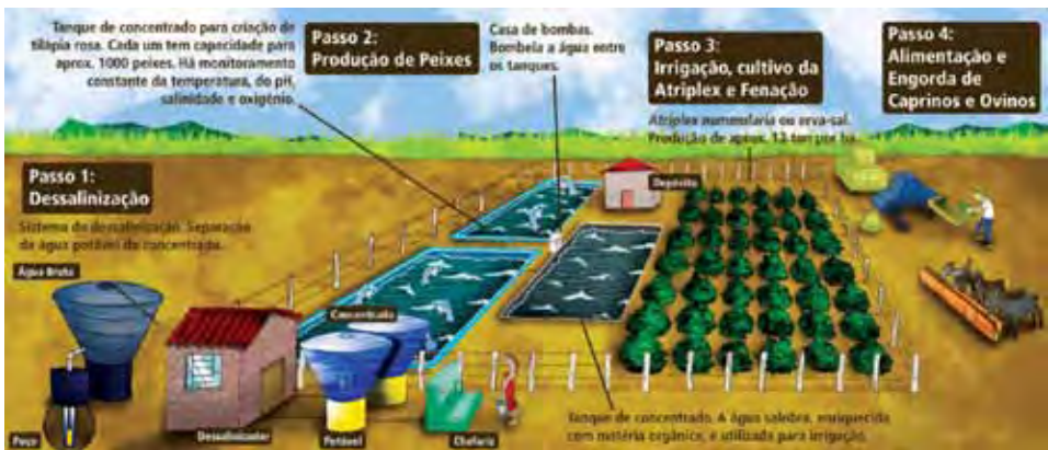
Figura 20 Ilustração do sistema completo do Programa Água Doce Fonte: Brasil, 2011, p.2
